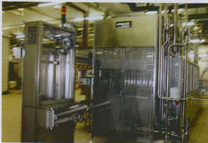
Verpackungsmaterial, hier Becher, werden den Füllern vom Untergeschoss aus zugeführt
